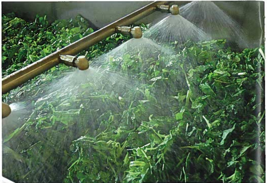
Ennen muuta prosessointia kotimainen pinaatti pestään ja huuhdellaan Säkylän vihannestehtaalla. Kuvassa pinaatti on huuhtelussa.
